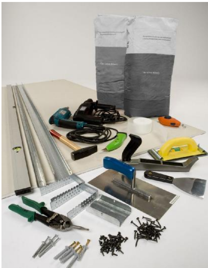
Rys.8. Narzędzia i materiały stosowane w montażu suchej zabudowy
